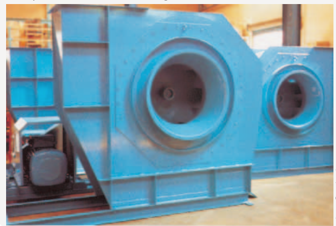
Fig. 8 Exemple de ventilateur centrifuge
