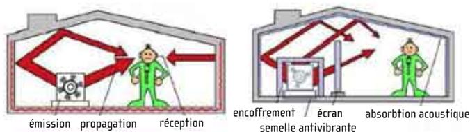
Un traitement acoustique de l'atelier est également une solution. La réduction du niveau sonore est significative.
